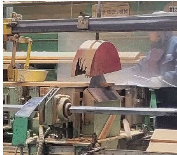
安全装置が破損
