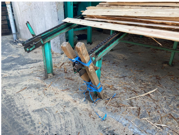
壊れた状態 応急処置のまま
